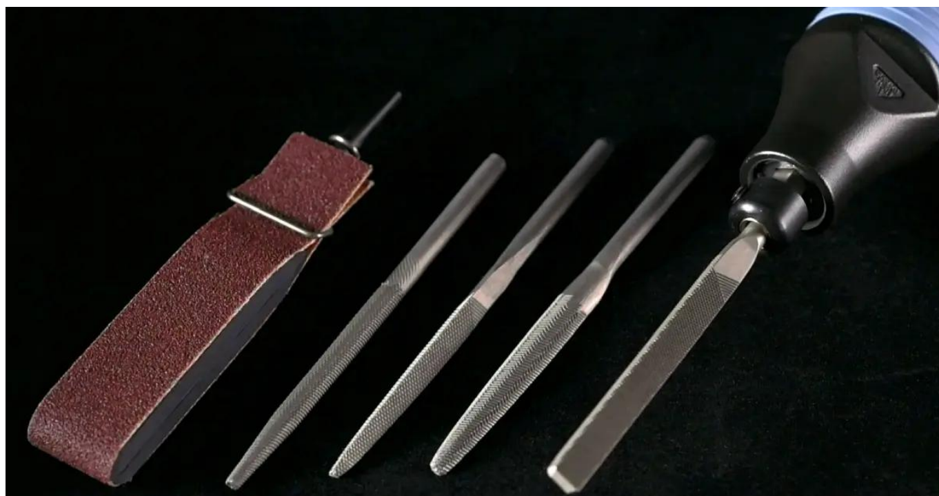
Różne warianty pilników z uchwytem 5 mm możliwych do zastosowania z pilnikarką Nitto Kohki ASH-900
